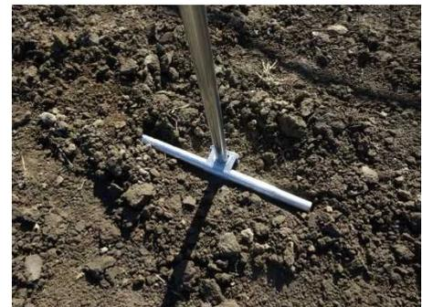
図28 パイプの沈下防止
