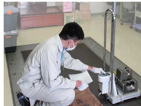
↑ 体重計の検定の様子です。検査員が表示値を確認しているところです。
