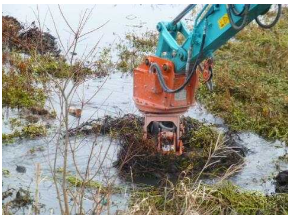
中型重機の「グラップル」という特殊アタッチメントでつかむ グラップルはグルグル回るので水草を巻き付ける
