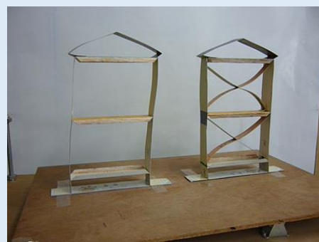
紙模型の作成、振動実験
