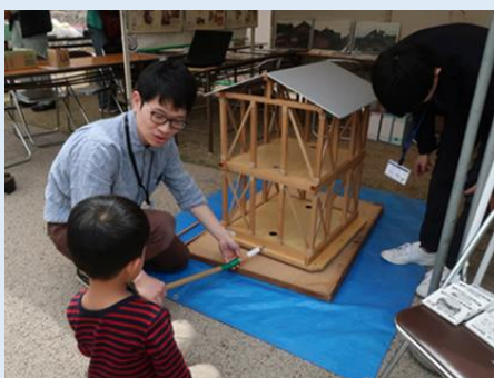
住宅模型の倒壊実験
