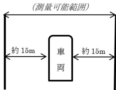
(車載写真レーザ測量のイメージ)
