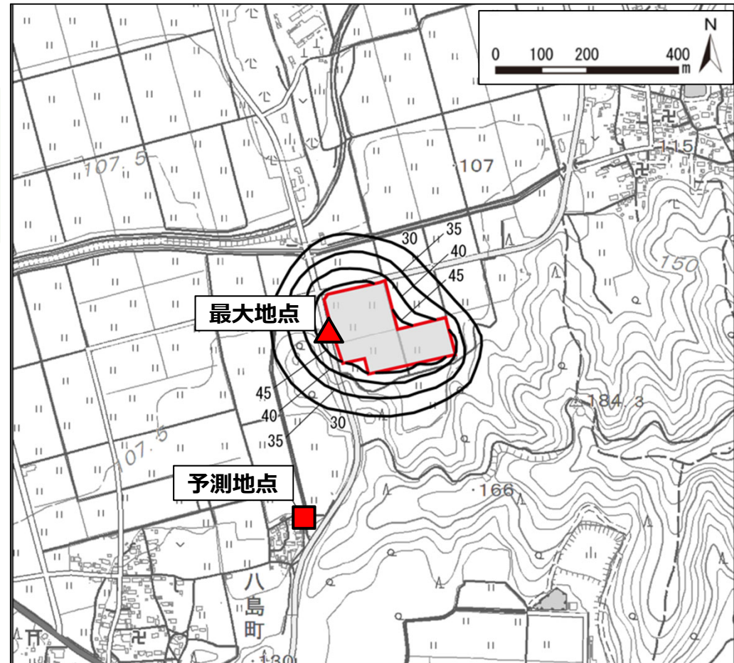
工事中の振動予測地点と最大地点位置
