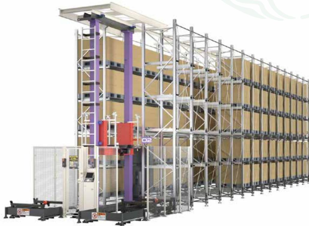
従来のパレット系自動倉庫をモデルチェンジし、省エネ・CO<sub>2</sub>削減に寄与。物流倉庫の自動化・高速化を支える昇降式クレーン。
