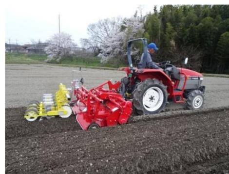
写真3 導入した畝立同時播種機
