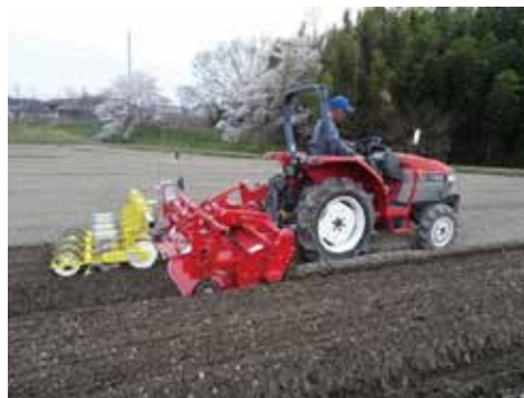
写真3 導入した畝立同時播種機
