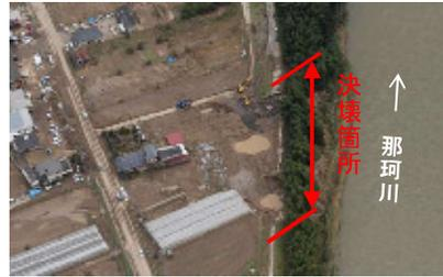
写真③堤防決壊状況（那珂川左岸40.0k）
