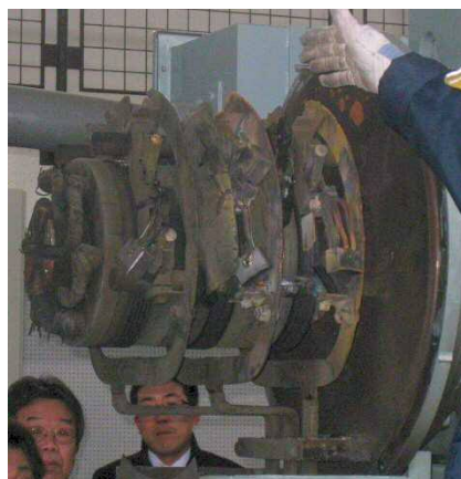
揚水機(高圧電動機)の焼損による緊急停止事故
