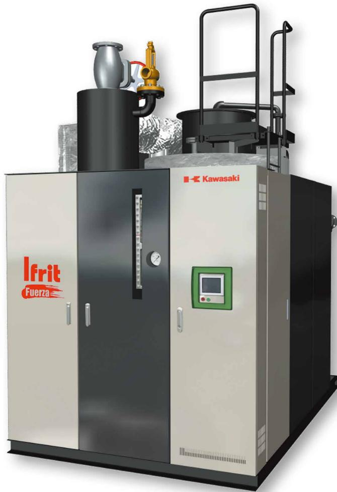
大型貫流ボイラ「イフリート」は、従来の高性能缶体に新開発した高性能エコマイザーを搭載することにより業界トップクラスのボイラ効率99%を達成いたしました。また、2種類の高性能フィンの組み合わせにより、低温給水時における腐食に対応しています。
