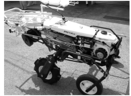
図1 供試した野菜移植機 (ヤンマーPN1Aw)
