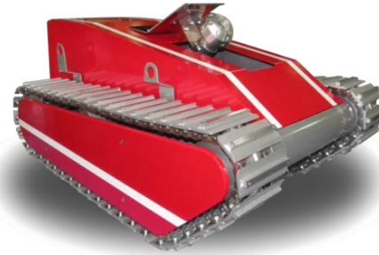
廃炉現場用消火ロボット
