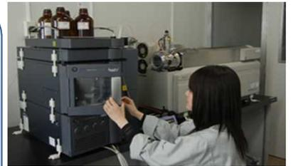
液体クロマトグラフ質量分析による食品検査
