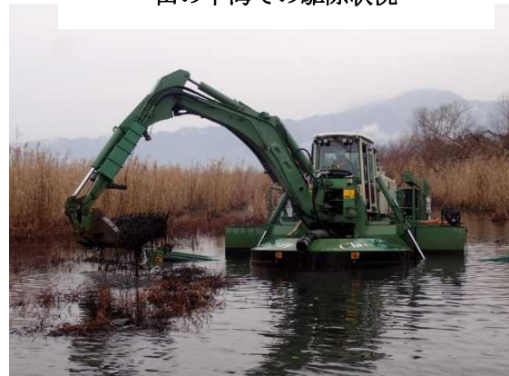
多機能作業船「ウォーターマスター」での試験駆除（1号試験施工業務）
