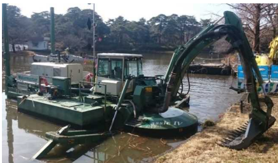
多機能作業船「ウォーターマスター」での試験駆除（1号試験施工業務）
