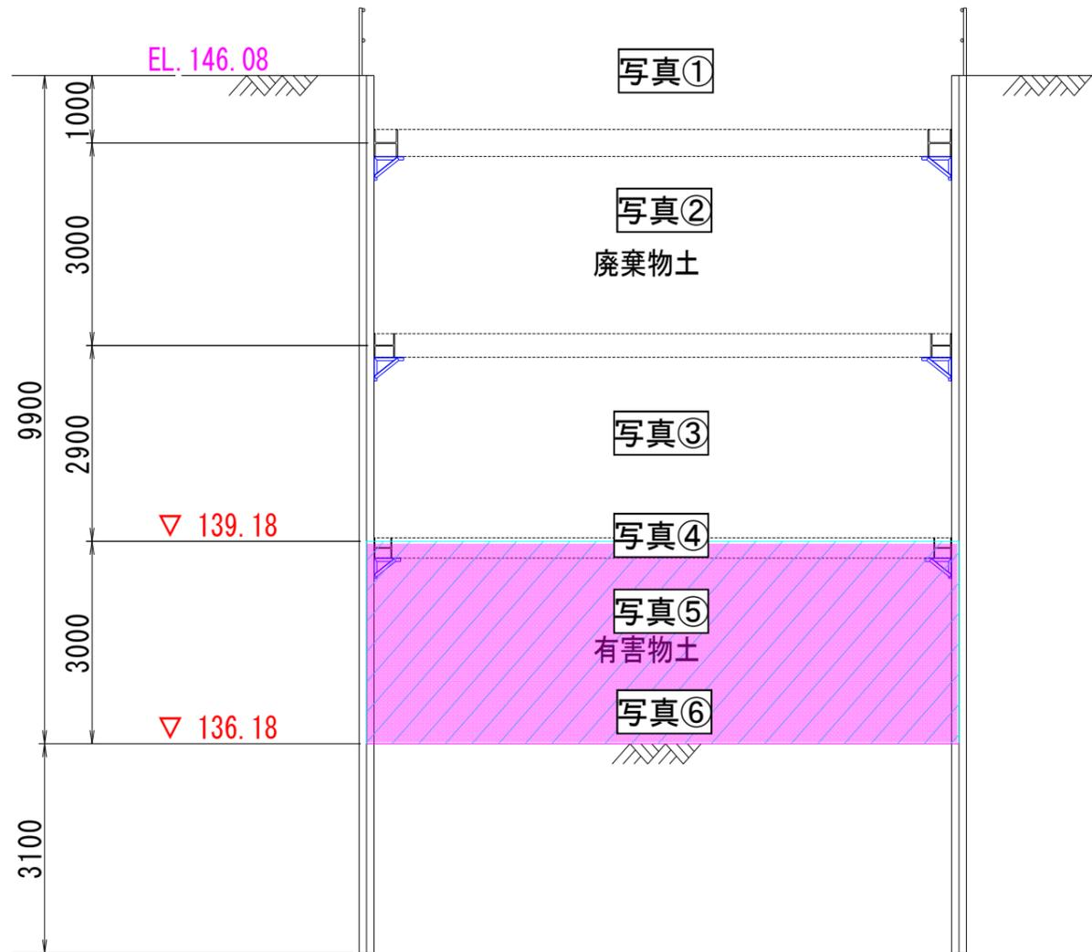
写真① 1次掘削完了(廃棄物土)
