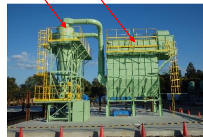
振動風力選別機用 サイクロンセパレータ[左]と集塵機[右]
