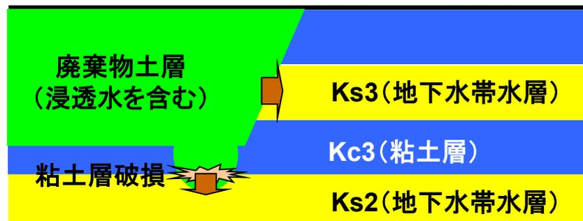
◆ 廃棄物土層が側面で地下水(Ks3)帯水層に接していることにより、浸透水が地下水層に移流拡散している
