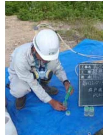
写真-1 孔内水位の測定状況
