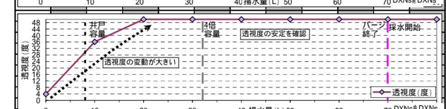
図 3(1/2) 採水時の水質変動測定結果(場内浸透水 バージ量が4倍容量前後よりも多い6孔)
