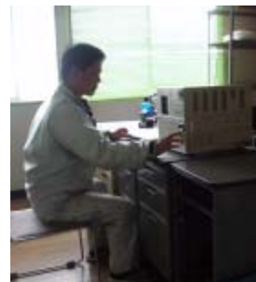
写真-2 ポータブルガスクロマトグラフでのVOC測定
