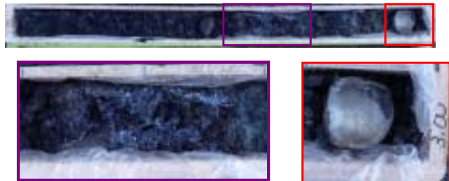
【県 H22-ケ-4 孔深度 2～3m のコア状況】
