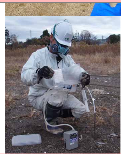
写真-4 表層ガス採取状況
