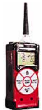
写真 6 携帯型ガス測定器(理研計器製GX-2003等)
