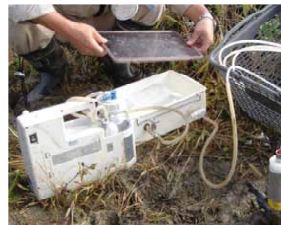
写真 4 表層ガス採取状況
