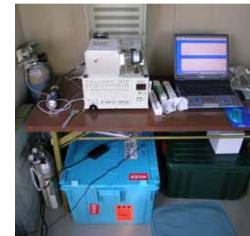
写真 5 ポータブルガスクロマトグラフィでのVOC測定
