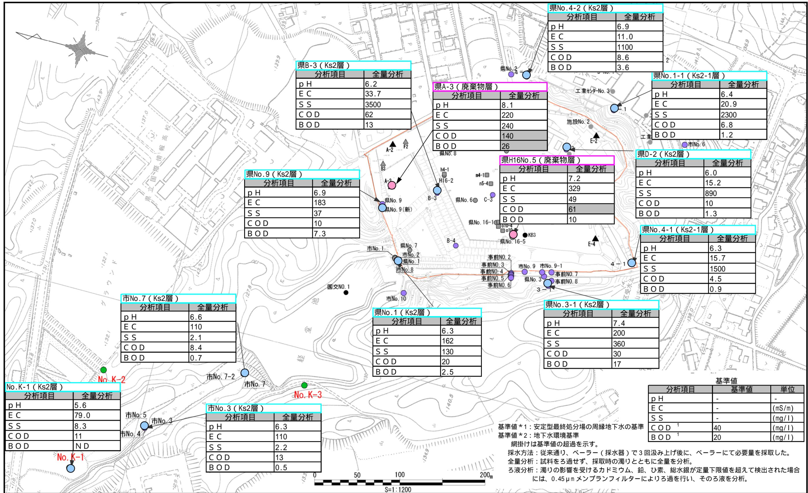
図 - 18(3/3) 処分場内および周縁のモニタリング結果図(平成 22 年 7 月採水分)
