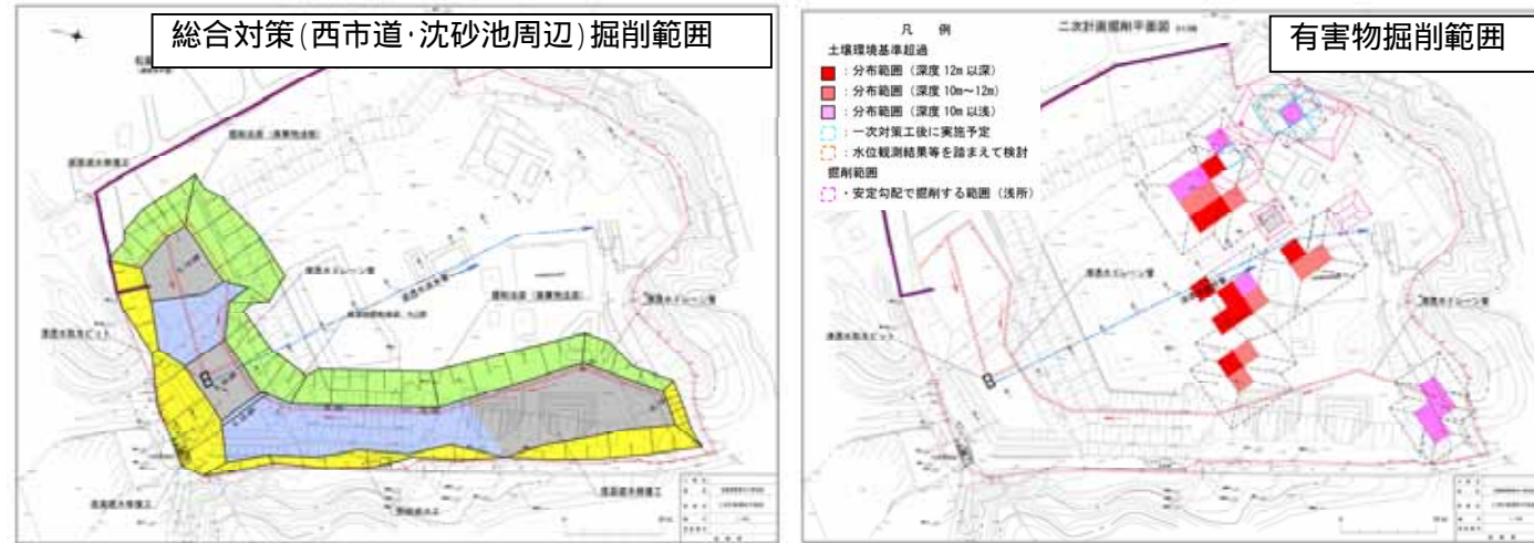
図 2.2-1 総合対策掘削範囲および有害物掘削範囲
