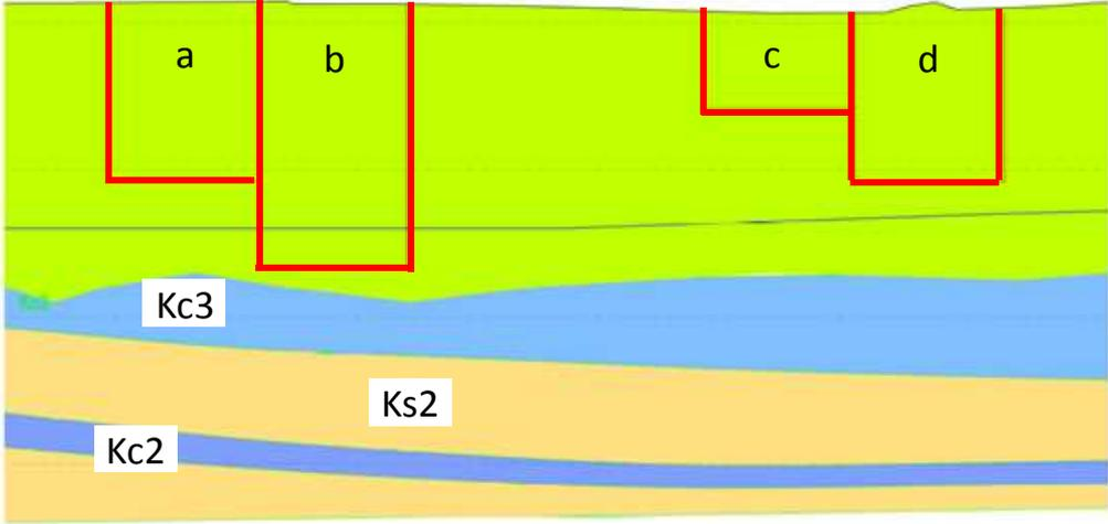
有害物掘削除去区画 断面図(例)
