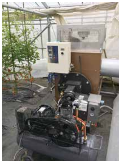
(株)水口テクノスの廃食油専用温風機 (甲賀市:発電量45,000kcal/h)
