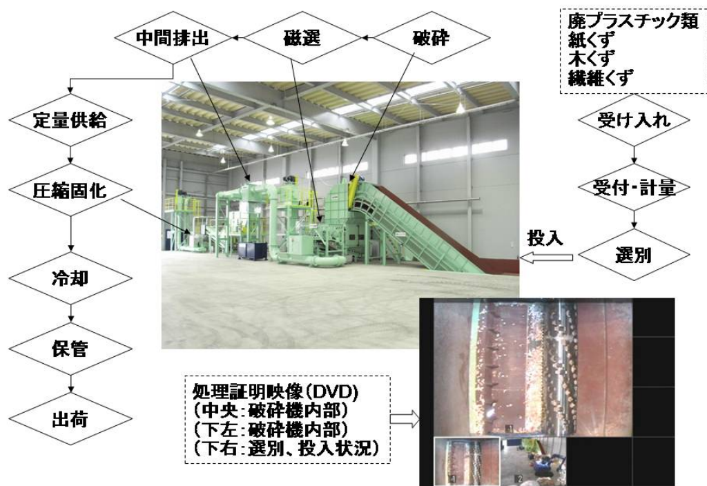
図 RPF製造設備、工程フロー及び処理証明映像
