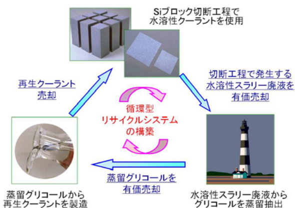
図2 水溶性クーラントの循環型リサイクルシステム
