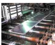
スラブを圧延し缶材にします。
