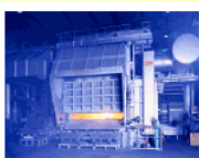
アルミ缶を溶解し、圧延用スラブに鋳造します。
