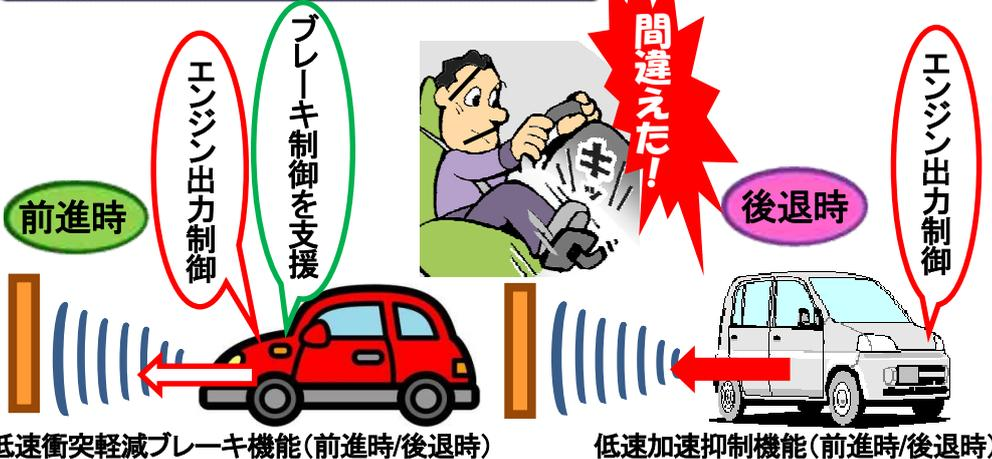
停止時や低速走行時に、車載のレーダー、カメラ、ソナーが前方（及び後方）の壁や車両を検知している状態でアクセルを踏み込んだ場合には、エンジン出力を抑える等により、急加速を防止
