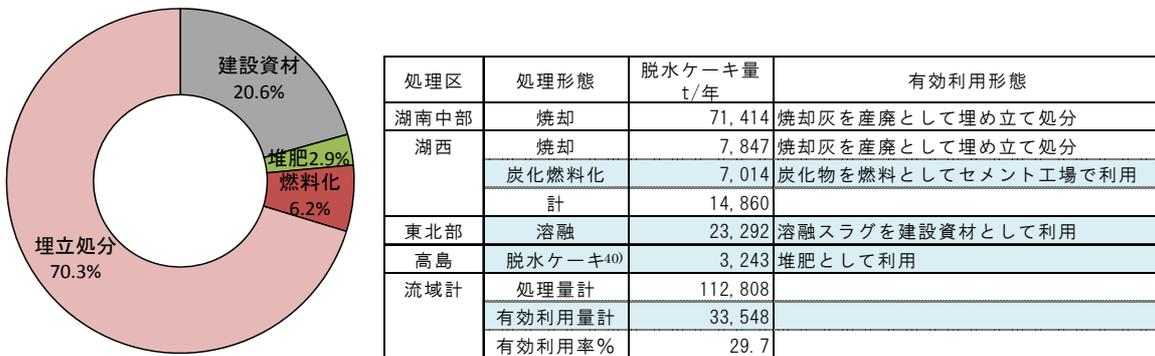
図 3-3-11. 平成27年度時点の下水汚泥の再利用状況
