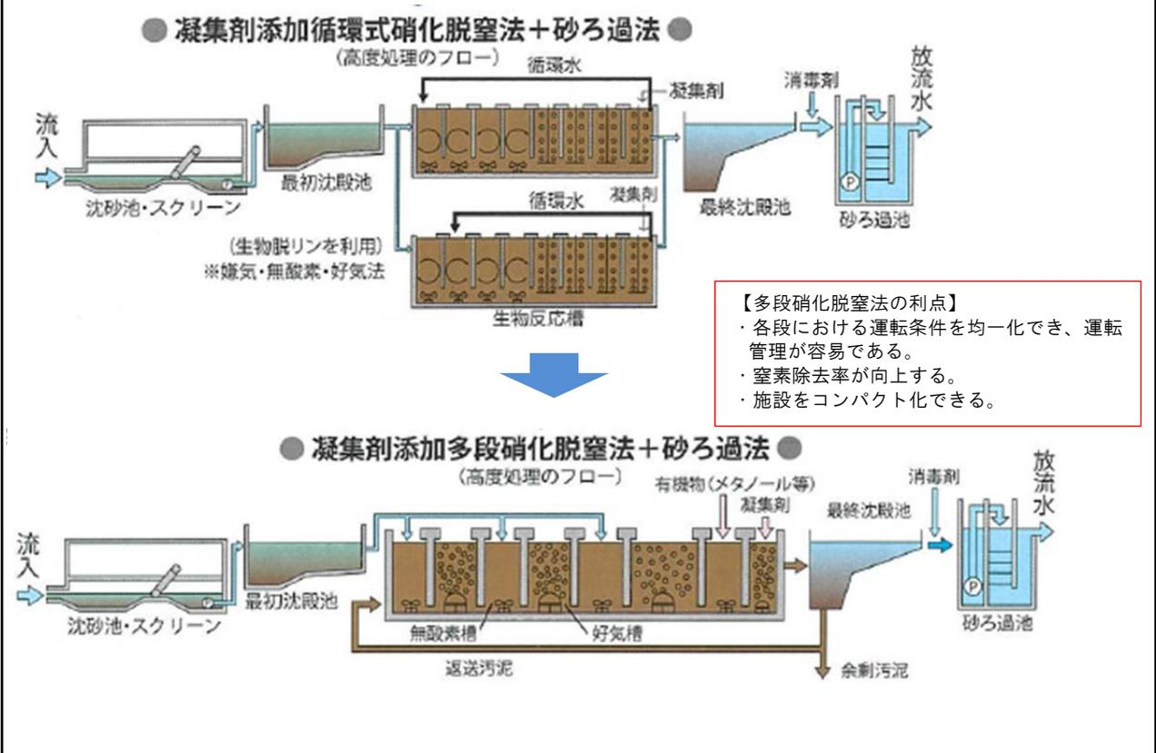
図 3-3-8. 多段硝化脱窒法 (ST 多段法) の概要
