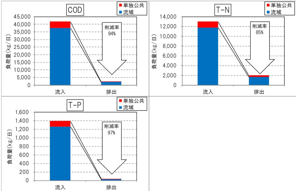
図 3-3-6. 滋賀県内の流域下水道処理場における汚濁負荷量削減状況 (H27)
