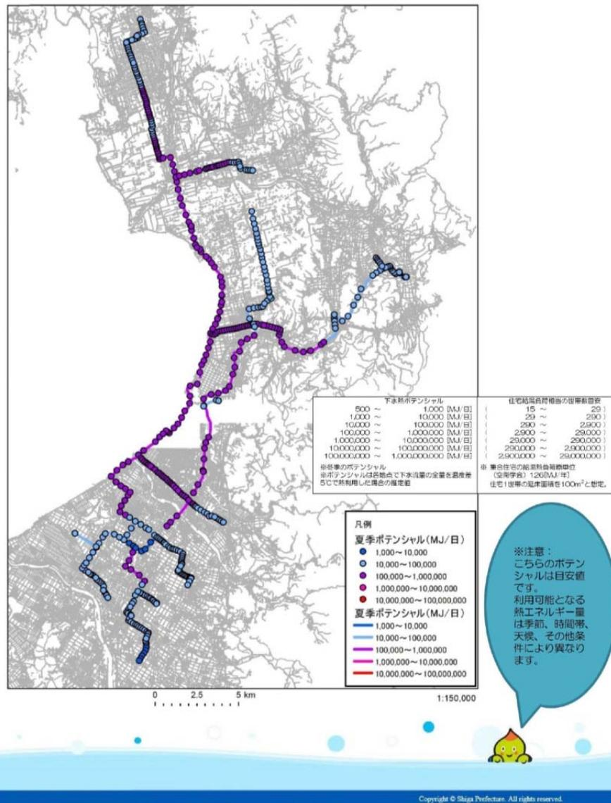
図 3-3-23. 下水熱ポテンシャルマップ（東北部処理区）
