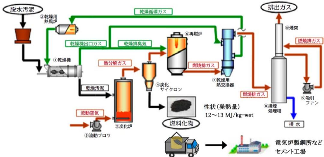
図 3-3-13. 湖西浄化センターにおける燃料化のフロー（流動床式炭化システム）
