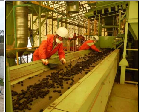
④ 選別処理工 25～50mm重量物の手選別を行っています。
