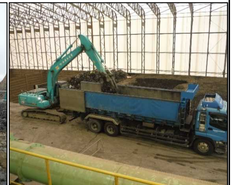
④ 選別処理工 可燃物を搬出するため積込みを行っています。
