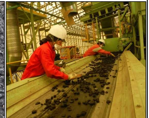
④ 選別処理工 25~50mm物の手選別を行っている様子です。
