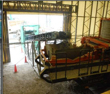
④ 選別処理工 自走式スクリーン(E-7)で選別した120mmアンダー物に選別助剤を添加し改質を行っています。
