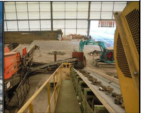
③ 選別処理工 50~100mm物がスクリーンによって選別され排出している様子です。
