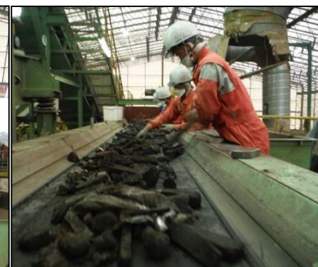
③ 選別処理工 50～100mm物から可燃物、不燃物を人力で選別しています。
