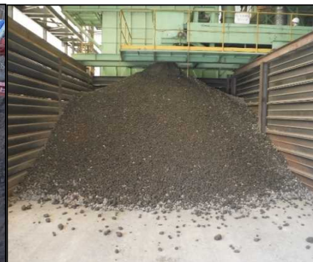
④ 選別処理工 選別された25～50mm選別土です。
