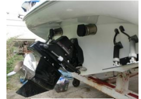
排気口の外観
