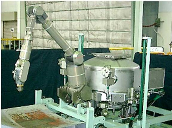
燃料取換クレーンにより目視点検装置、渦流探傷試験装置を吊り下げて試験
