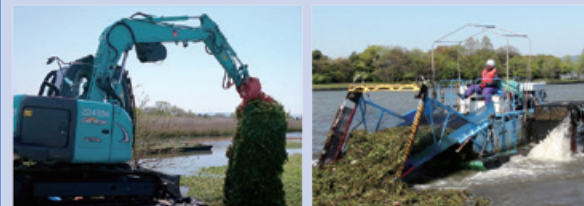
写真T-2 オオバナミズキンバイの駆除に用いられる 建設機械(左)と水草刈取り船(右)
