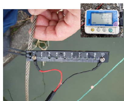
図 2 電極直近の 2 点間の電圧を測定するプローブと電圧ロガー
