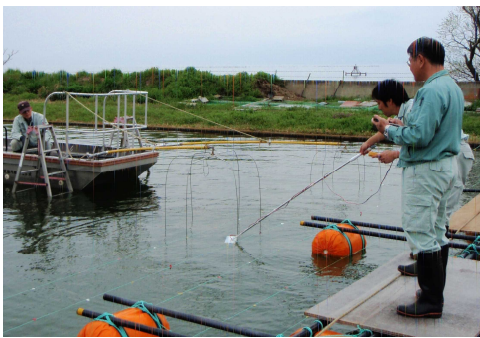
図1 試験池での電圧分布測定状況
