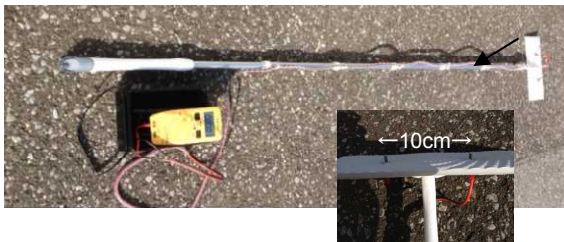
図2 水中の2点間(10cm)の電圧を測定するプローブとデジタルテスター
