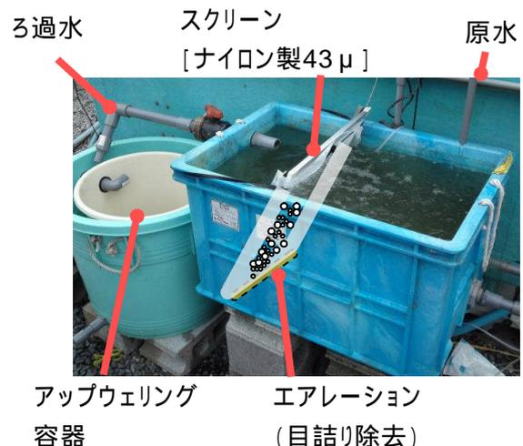
図1 簡易濾過装置の概略図
