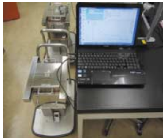
写真1. NaI(Tl)シンチレーションスペクトロメータ
