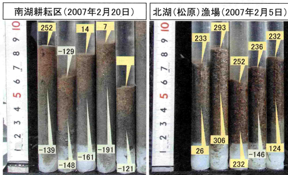
図2 小型コアサンプラーで採取した底質柱状サンプルの外観と部位別ORP測定結果。
