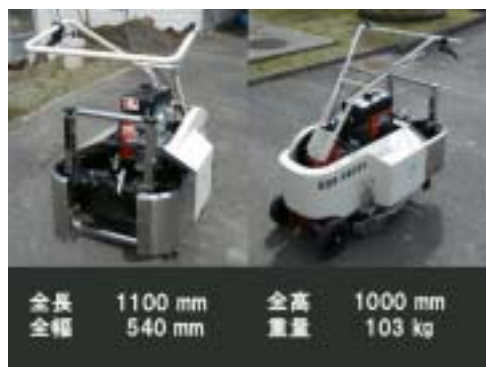
図1 マルチ敷設機の概要
