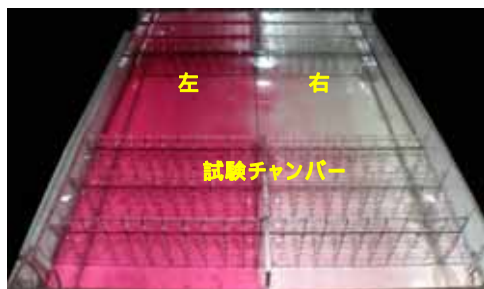
図1 並流型忌避試験装置(左に色素を流した場合) 試験チャンパー内を左右異なる水が流れる。 魚は左右移動可能。
