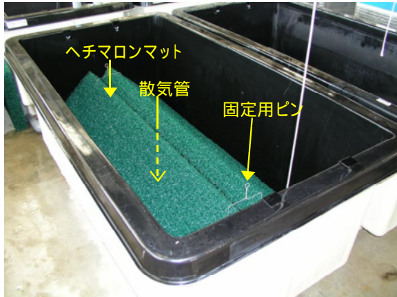
図1 採卵槽（1トンFRP水槽）に敷設した立体網状マット（商品名：ヘチマロン）。散気管は底面中央に設置。
